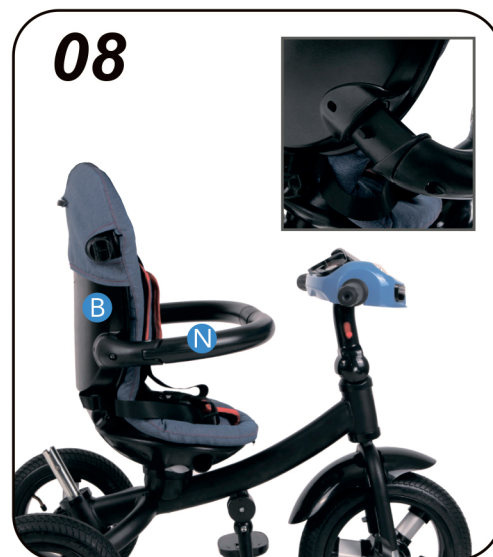
8. Установите дугу безопасности (N) в отверстия сидения (B).
