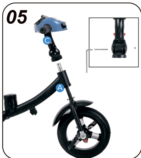
5. Установите руль (C) на раму (A). Зафиксируйте крепеж.
