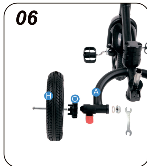
6. Установите задние колеса и затяните гайкой с внутренней стороны рамы.
